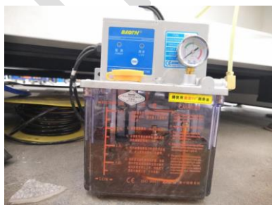
Автоматическая система смазки рельсов
